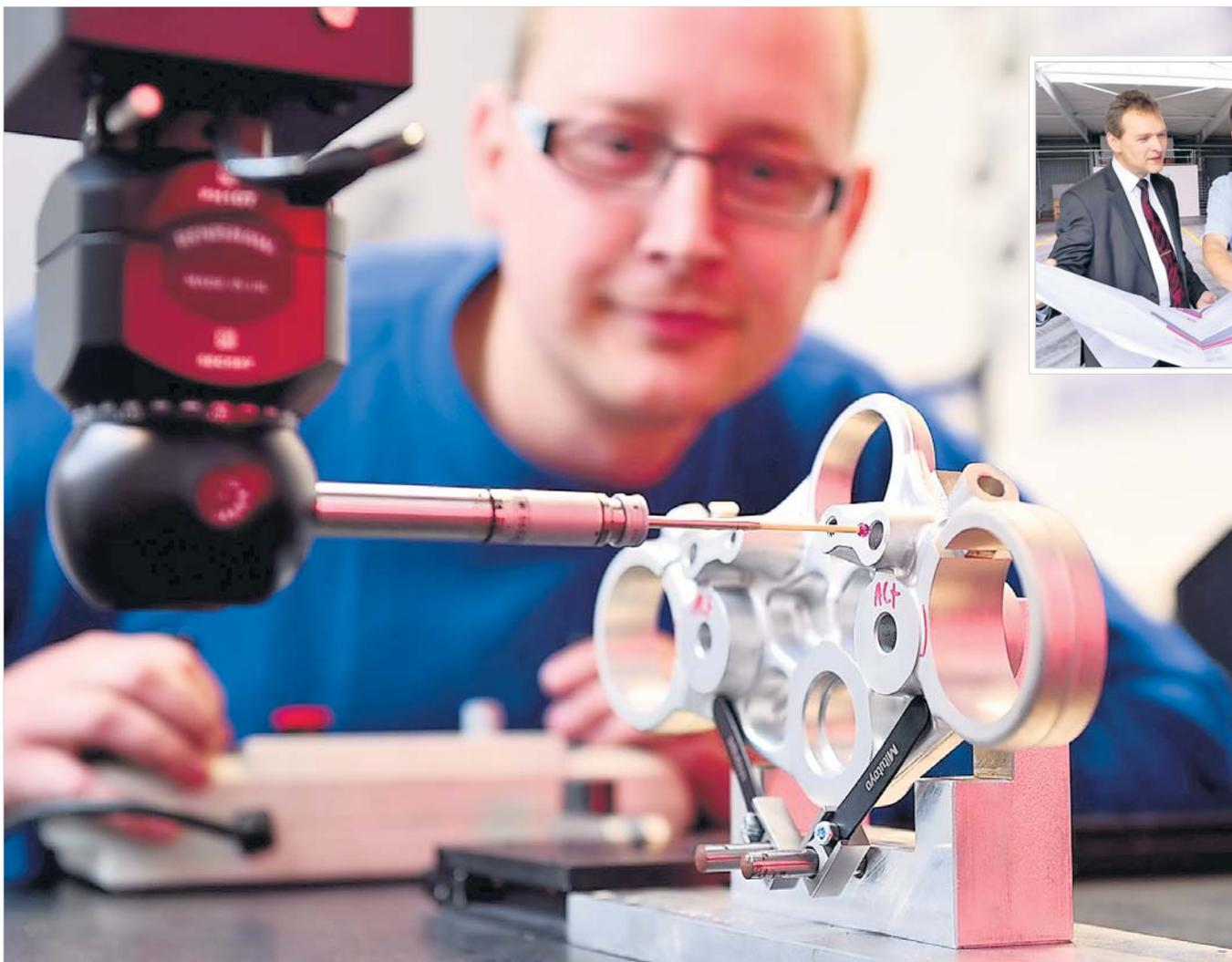
Robert Schlapp prüft an einem Aluminiumteil, ob die geforderte Messtoleranz eingehalten wird. Kleines Bild: Die Geschäftsführer der Aluminiumtechnik Radebeul GmbH Stephan Schneider (links) und Mike Müller mit dem Plan für die neue Produktionshalle auf der Fabrikstraße.
